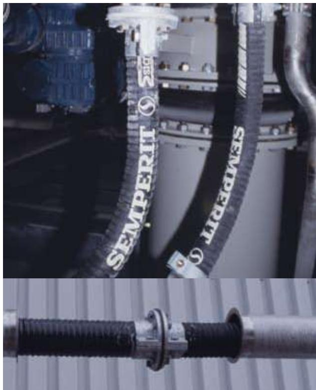
При транспортировке твердых материалов, особенно в закрытых помещениях, уровень шума по сравнению с со стальными трубопроводами много ниже. Внутренний слой из каучука поглощает большую часть звуковой энергии и сокращает таким образом шумовую нагрузку.
