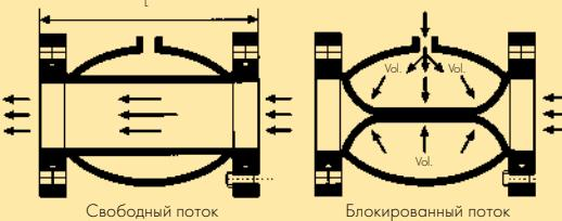
Опрессовочный вентиль в простом и массивном исполнении. Средство управления: сжатый воздух или вода, сжимает цилиндрическую эластичную манжету, поток блокируется (или уменьшается).
