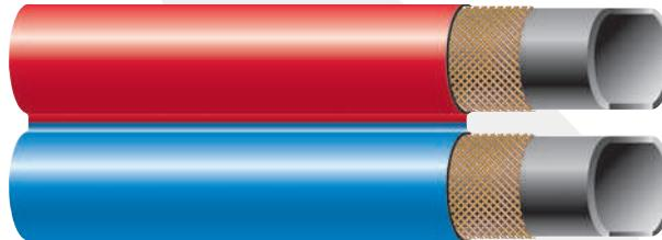
**Температурный режим:** -30°C / +70°C.**Запас прочности:** 3 : 1**Внутренний слой:** EPDM, черный, гладкий.**Армирование:** Тканевое усиление, навивка.**Наружный слой:** EPDM, синий и красный, гладкий.**Обозначение:** непрерывная лазерная маркировка: "SEMPERIT S TWIN ISO 3821 (EN559) PN 2MPa (20 bar) DN -30°C Квартал/год Made in EU".
