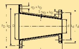
Бесступенчатый переход с помощью или без дренажных патрубков.
