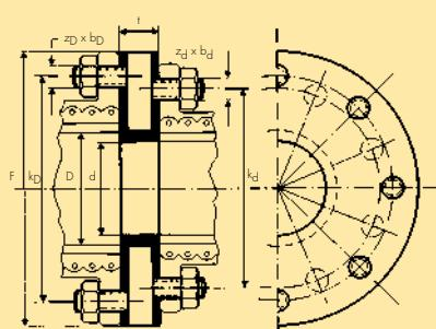
Изменение диаметра сечения в ограниченном пространстве без учета условий течения. Изоляцией служит двусторонний резиновый слой. Направление течения всегда от меньшего к большему диаметру сечения.
