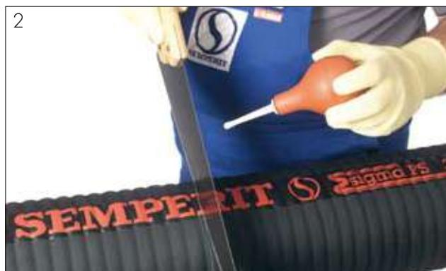
2. Отрежьте шланг по разметке с помощью острого, увлажненного режущего инструмента (например ножом или беззубной ножовкой) до проволочной спирали.
